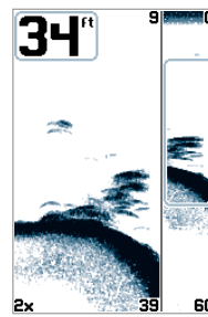
L'affichage zoom du sonar est montré avec l'identification de structure (Structure ID)
